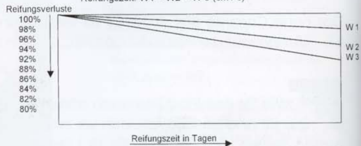
Tendenzieller Einfluss der Luftbewegung während der Reifungszeit. W1 < W2 < W3 (cm / s)
